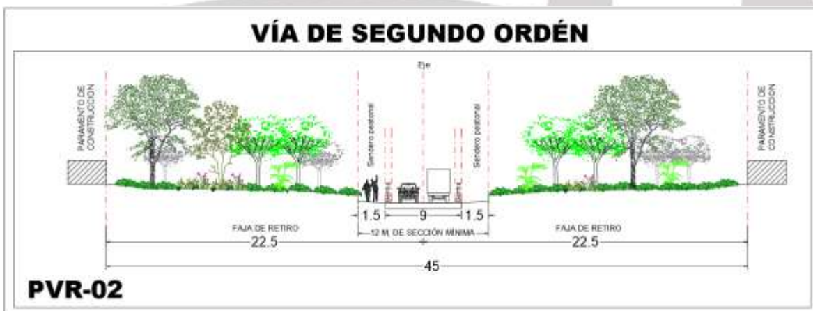
Figura 29. Perfil PVR-02 de vía de segundo orden.
